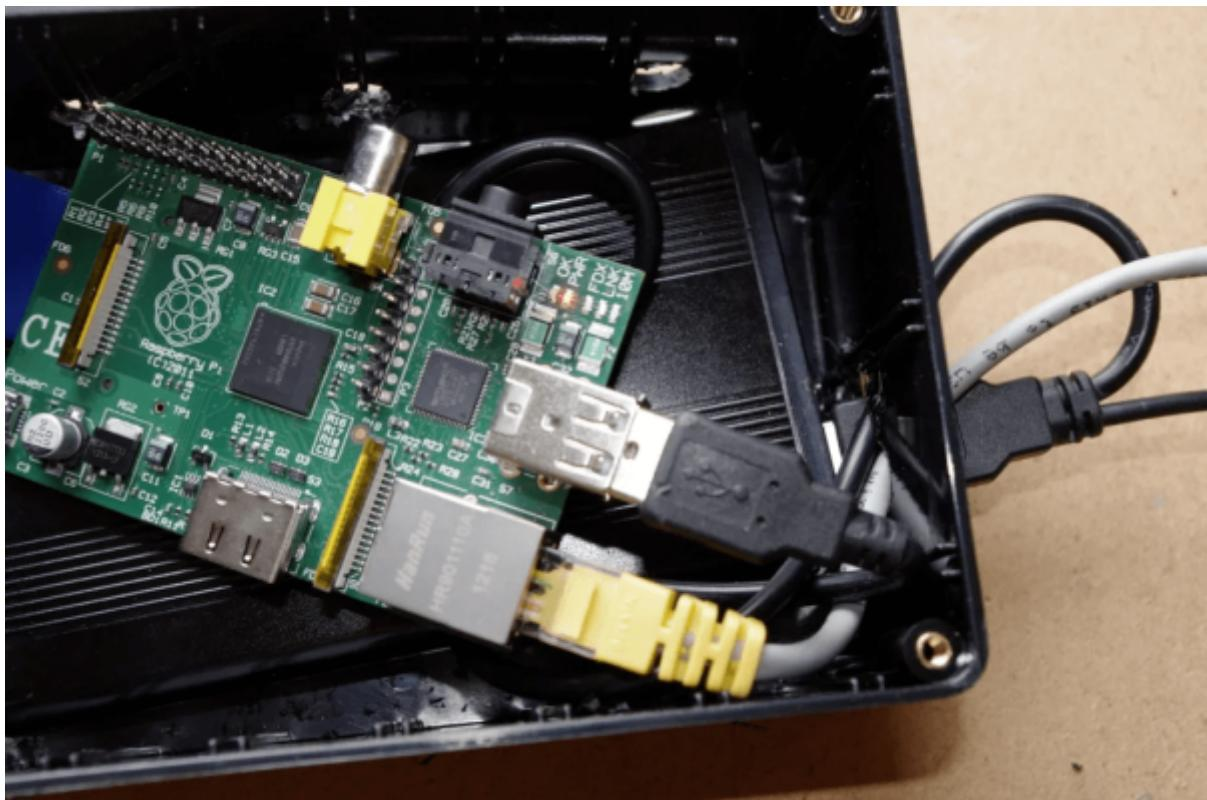
Maintenant que le logiciel est configuré, le Pi n'a plus qu'à être placé dans la boîte. Je percerais un trou dans la boîte pour permettre un peu de circulation d'air.
