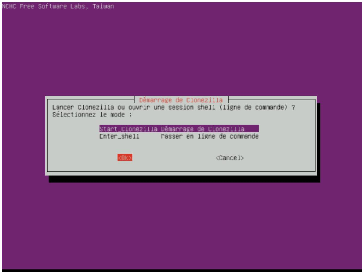
Mode de clonage : **device-image disque/partition vers/depuis image**. Clonezilla propose deux modes de clonage :
