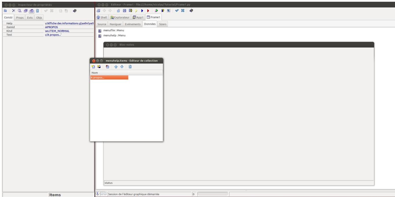
Dans l'inspecteur de propriétés, sélectionnez l'onglet Événements ('Evts'). C'est le volet utilisé pour configurer des événements. Nous avons besoin de configurer l'action qui se produit lorsque l'élément de menu 'A propos de' est sélectionné. Lorsque l'élément de menu 'A propos de' est sélectionné, l'événement appelé «EVT\_MENU » est généré et envoyé à notre programme. Nous devons ajouter une méthode à notre classe pour gérer cet événement.
