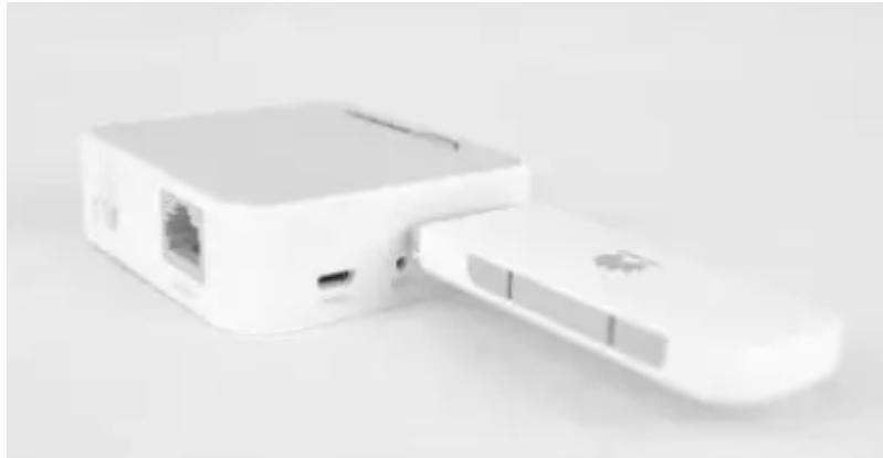
**le routeur TL-WR902AC** sur une **prise secteur** ou un port **USB** d'un ordinateur. Pour une utilisation permanente, préférez la connexion à une prise secteur.
