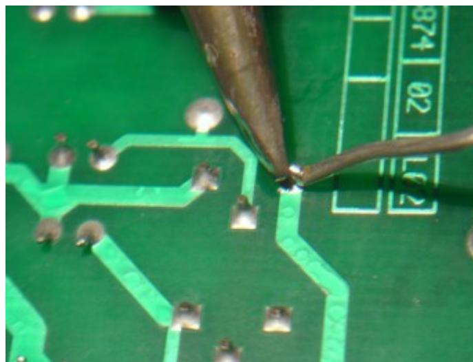
La soudure refaite a une allure différente (mélange neuf étain-plomb qui fond à 180°C)
