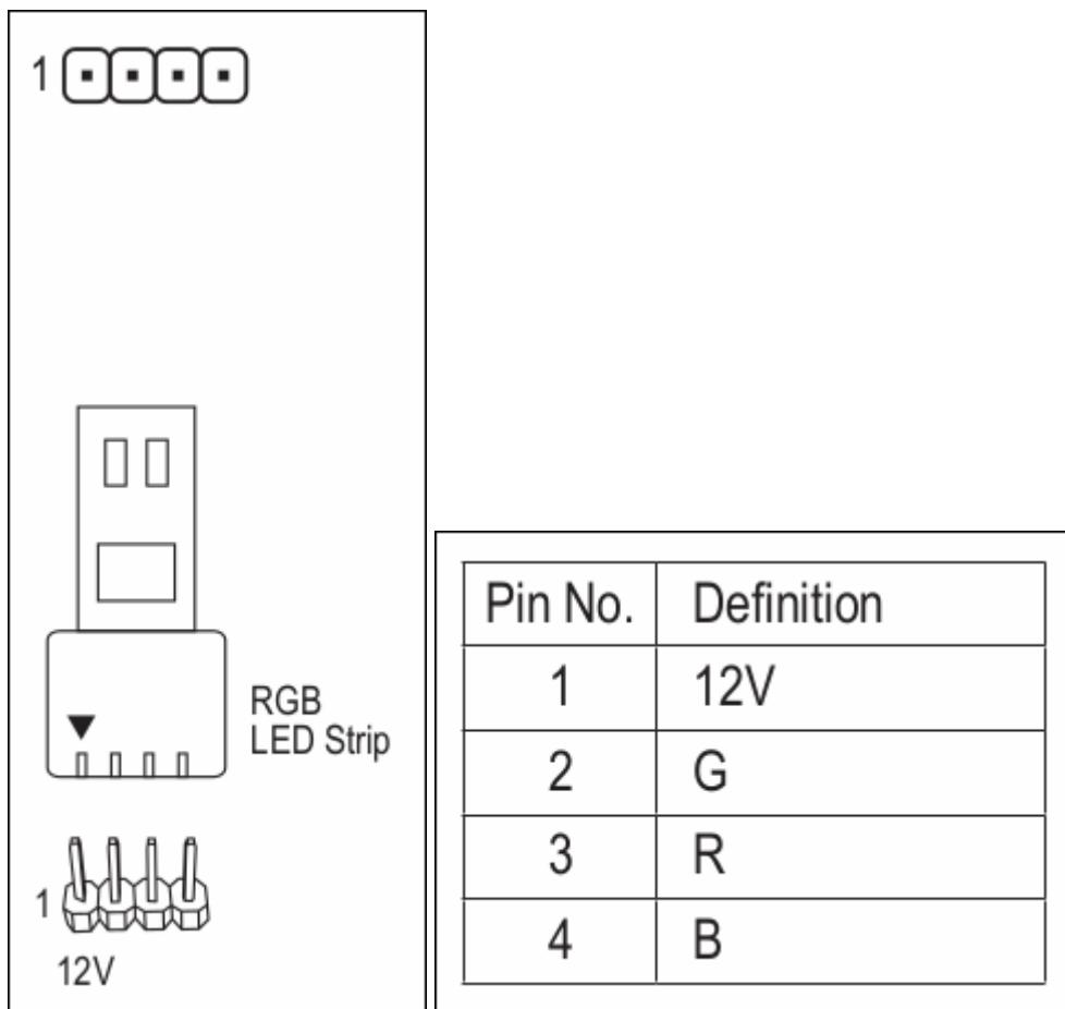
Connectez votre bande LED RGB à l'embase. La broche d'alimentation (marquée d'un triangle sur la fiche) de la bande LED doit être connectée à la broche 1 (12V) de l'embase de bande LED numérique. Une connexion incorrecte peut endommager la bande LED.
