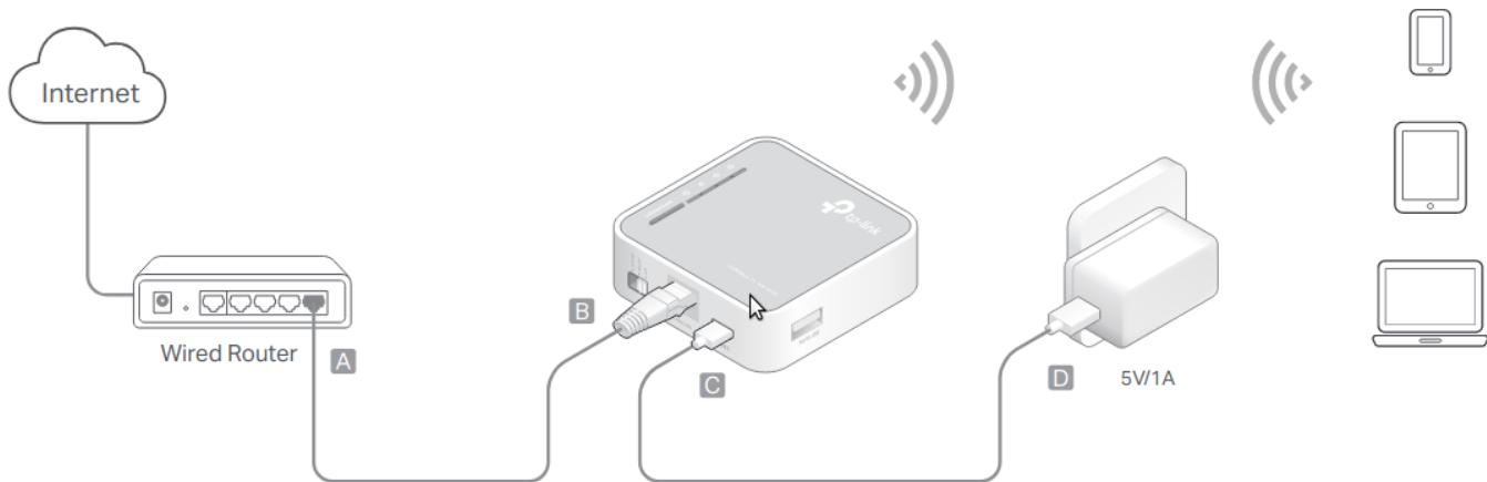
Basculez le mode de fonctionnement sur AP et connectez le matériel selon le schéma ci-dessus.
