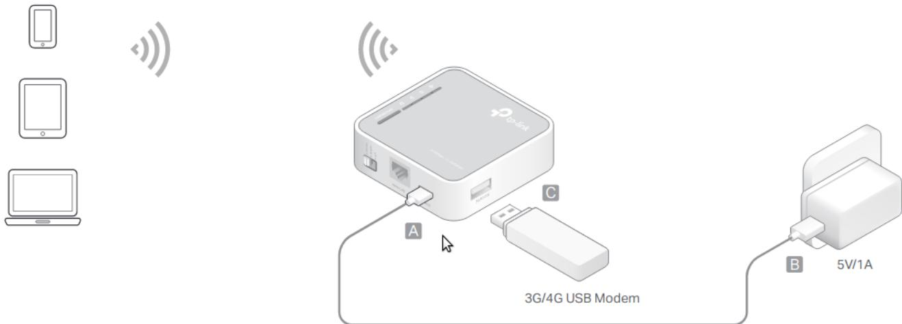
Basculez le mode de fonctionnement sur **3G/4G** et connectez le matériel selon le schéma ci-dessus. Connectez votre appareil au routeur sans fil. Le SSID (nom du réseau sans fil) et le mot de passe se trouvent sur l'étiquette du routeur.
