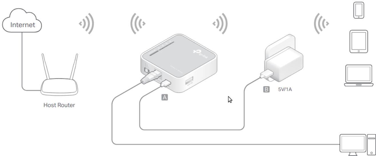
Basculez le mode de fonctionnement sur AP et connectez le matériel selon le schéma ci-dessus. Connectez votre appareil au routeur sans fil ou via un câble Ethernet. Le SSID (nom du réseau sans fil) et le mot de passe se trouvent sur l'étiquette du routeur.
