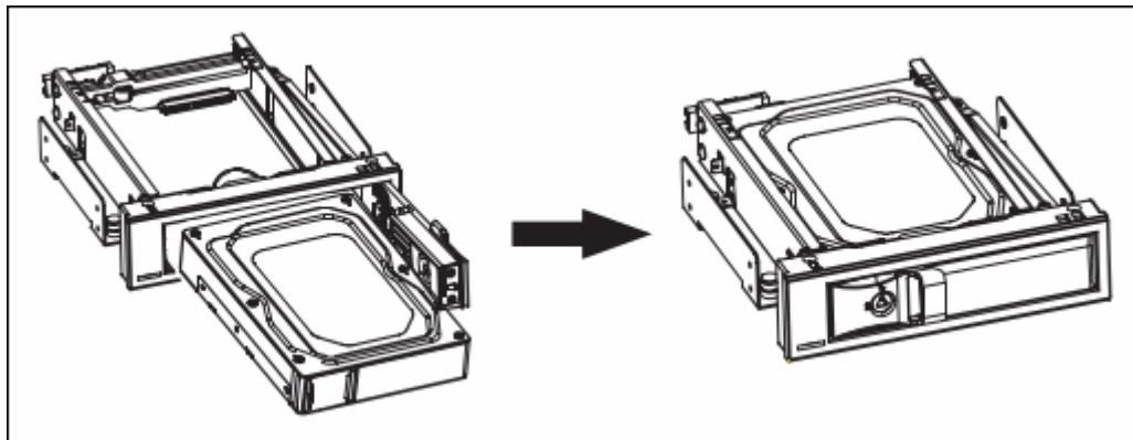
L'EMK3203 peut être utilisé dans tous les racks mobiles Enermax 5.25" tels que l'EMK5101, l'EMK5102 et l'EMK5201U3.
