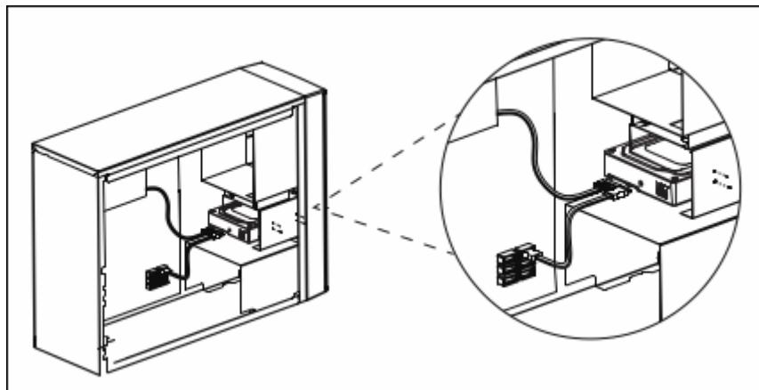
Installez l'EMK3203 dans l'emplacement de 3.5", fixez 2 vis de chaque côté.
